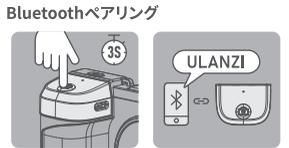
1. 撮影ボタンを3秒間長押しすると、リモコンがオンになり、緑インジケータライトが点滅します。3秒間長押しすると、電源が切れます。
