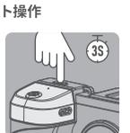
1. 電源ボタンを 3 秒間長押ししてオンにする、デフォルト輝度は30%輝度である、電源キーを短く押しして輝度を調整し、30%/70%/100%の3段階に分ける。もう一度3秒間を長押しして電源を切る。
