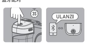
1. 长按拍照键3s打开遥控器, 绿色指示灯闪烁。长按3s关机。
